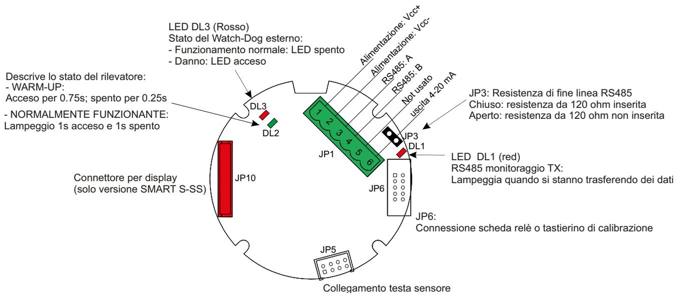
Figura 2) Schema topografico della scheda base equipaggiata con modulo HART
