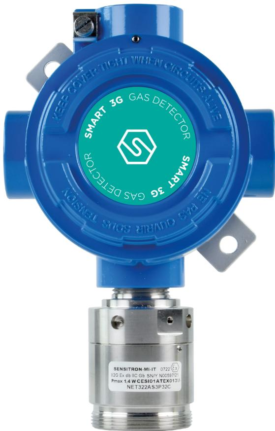
Il rilevatore SMART3G-C2 è adatto all'installazione in aree industriali e zone ATEX; grazie alla custodia a prova di esplosione può essere installato in zona 1 e, se munito dell'adattatore per polveri, in zona 21.
