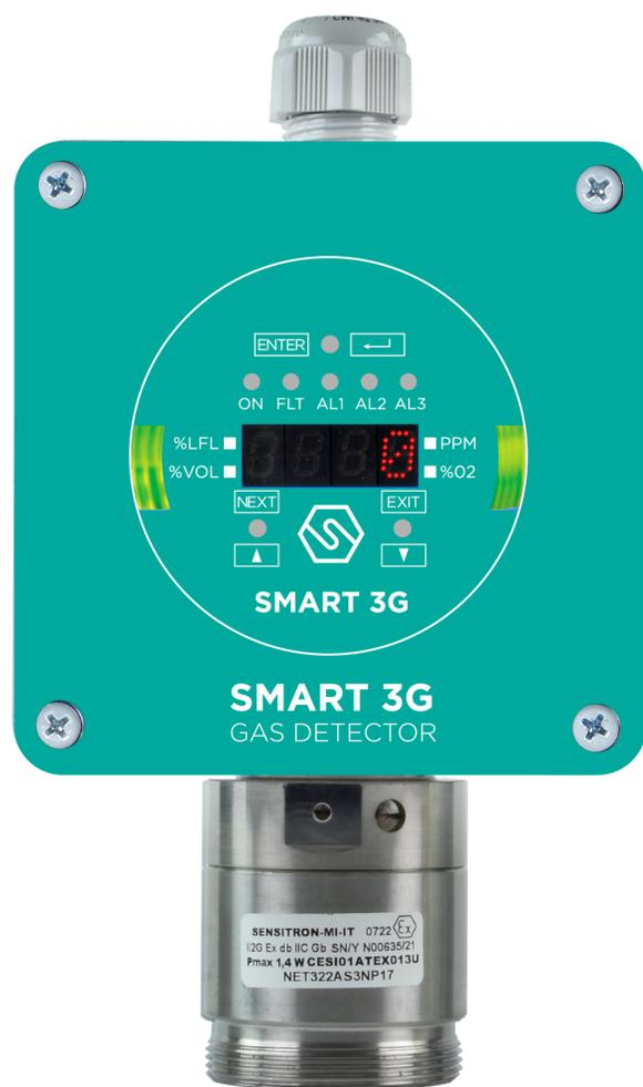
Il rilevatore SMART3G-D3 è adatto all'installazione in aree industriali e zone ATEX; può essere installato in zona 2 e, se munito dell'adattatore per polveri, in zona 22.
