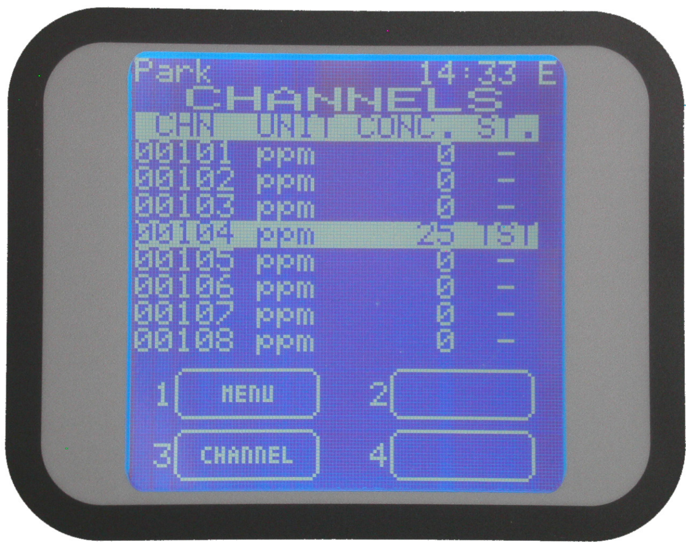
Figura 45 Videata con canali in Test
