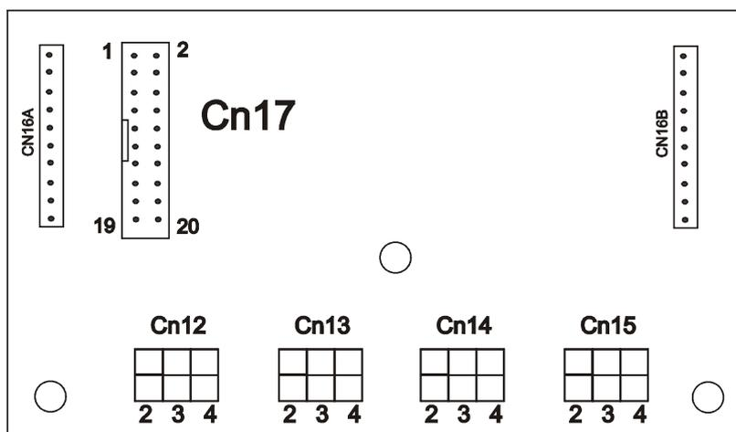
CN12, CN13, CN14, CN15 sono le morsettiere di collegamento dei rivelatori. Nel dettaglio CN12 (zona5), CN13 (zona 6), CN14 (zona 7), CN15 (zona 8).
